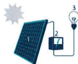
1 Zonnepaneel 2 Inverter 3 Stroomkabel
